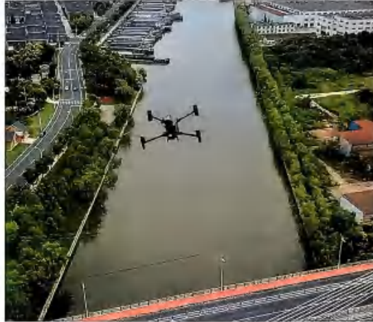
图 无人机河道巡航监测示意图
